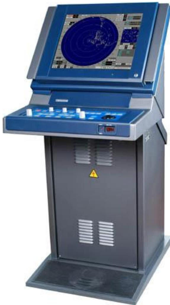
Рис. 1. Внешний вид прибора И (индикатор) РЛС «Наяда-25МЕ»
