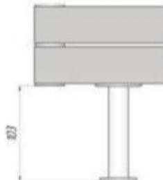
Для напольного исполнения радиаторов Параллели В нв с боковым подключением и количеством секций до 4 штук, необходимо согласовывать схему расположения ножек
