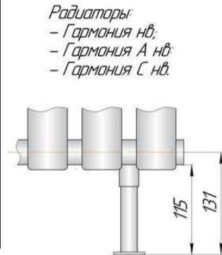
Для напольного исполнения радиаторов Гармония с нижним подключением и количеством секций до 7 штук, необходимо согласовывать схему расположения ножек.
