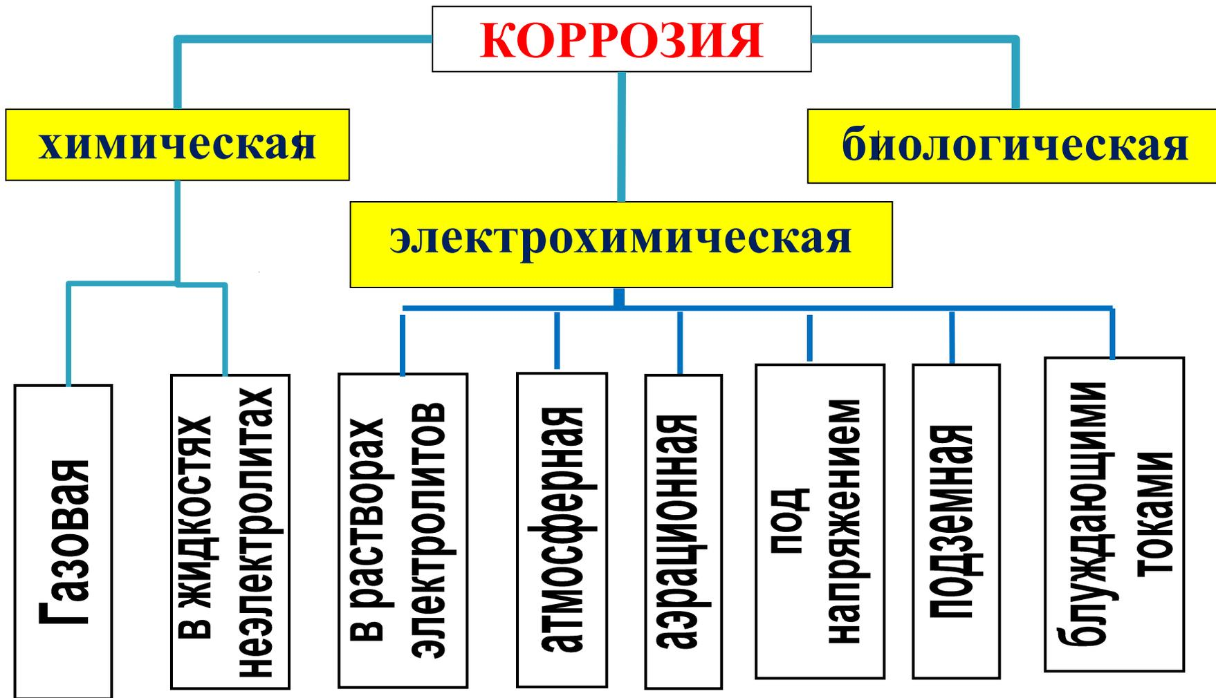
Рис. 1. Классификация коррозионных процессов
