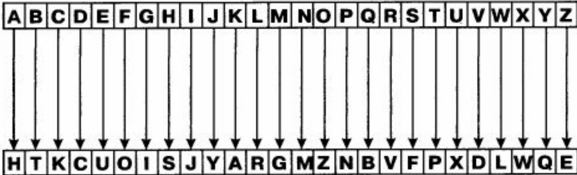
Рис. Простой подстановочный шифр
