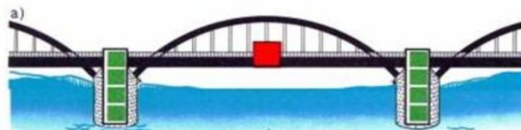
Для судов идущих снизу при габаритной высоте 16 м.
