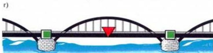
Для маломерных судов при габаритной высоте до 10 м.
