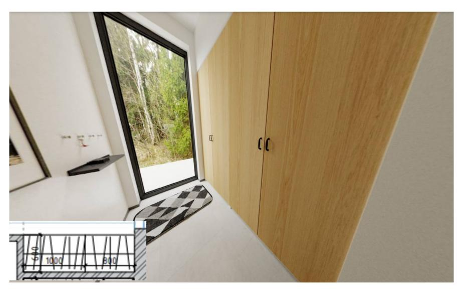
Делим пространство (1800) на 2части. Первая часть 800- это сидушка, внизу место для обуви, сверху полка. Вторая часть- две двери по 500 до потолка. Делаем такое же обрамление с торца как и в другой прихожей. Важная деталь по цоколю- делаем в одной плоскости с фасадом на всех шкафах. Коврик кладем плетеный из рогожки Текстура шкафа- как в другой прихожей- под
