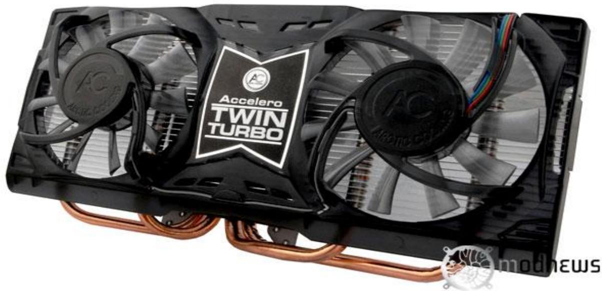
Система охлаждения — один из важнейших компонентов видеокарты, предназначенный для сохранения температурного режима графического процессора и видеопамяти в допустимых пределах. Косвенно влияет на производительность всего видеоадаптера.
