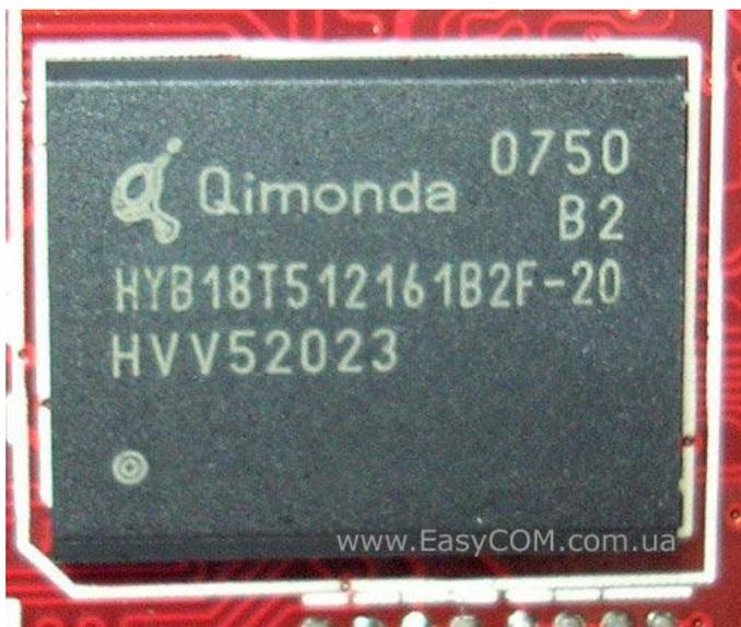
**Видеопамять** — тип оперативной памяти, предназначенный для хранения данных, использующихся для формирования изображения на экране монитора.
