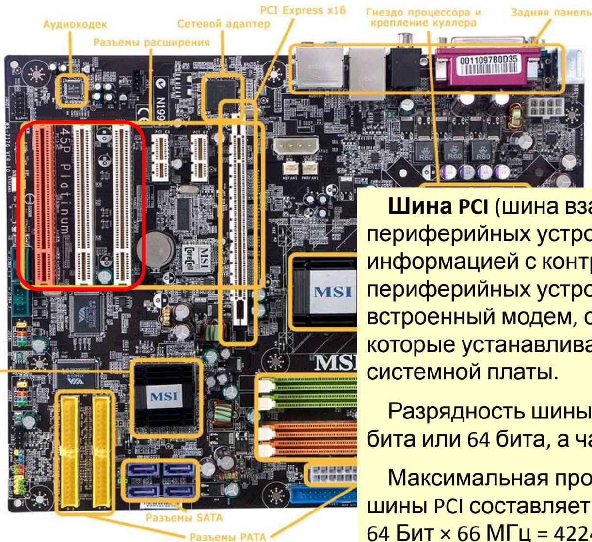
**Шина PCI** (шина взаимодействия периферийных устройств) обеспечивает обмен информацией с контроллерами периферийных устройств (сетевая карта, встроенный модем, сетевой адаптер Wi-Fi), которые устанавливаются в слоты расширения системной платы.
