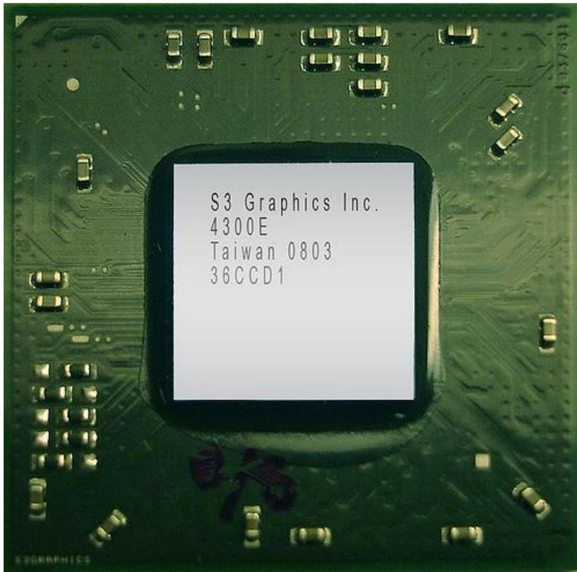
**Графический процессор** (ГП, GraphicsProcessing Unit, GPU) — компонент ПК или игровой приставки, выполняющий графический рендеринг. Современные ГП очень эффективно обрабатывают компьютерную графику. Благодаря специальной конвейерной архитектуре они намного эффективнее в обработке графической информации, чем центральный процессор.
