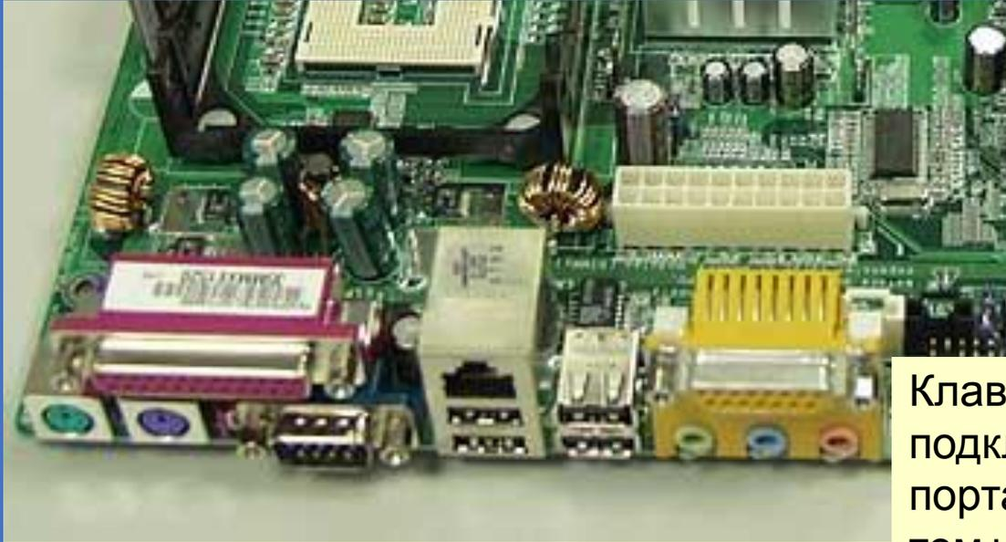
Клавиатура и мышь подключаются с помощью порта PS/2 или шины USB (в том числе с помощью беспроводного адаптера)
