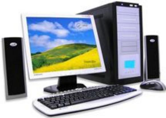
Компьютеры бывают различной «внешности». Есть настольные компьютеры, которых большинство. Состоят они из монитора (экрана) и коробки с внутренностями (системного блока). В обязательный набор входит также клавиатура и мышь. Всякие сканеры, принтеры, веб-камеры, звуковые колонки и пр. — это дополнительные и необязательные части компьютера.
