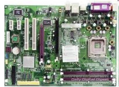
**Материнская плата (mother board)** – основная плата персонального компьютера, представляющая из себя лист стеклотекстолита, покрытый медной фольгой. Путем травления фольги получают тонкие медные проводники соединяющие электронные компоненты.
