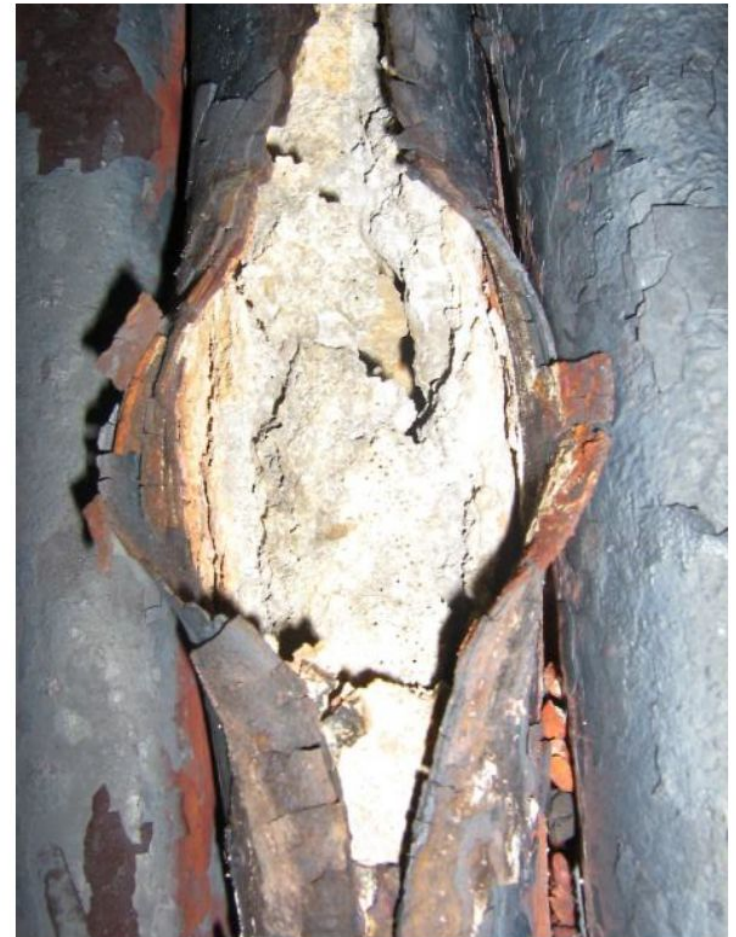
Рис.2. Труба поверхности нагрева котла забитая шламом
