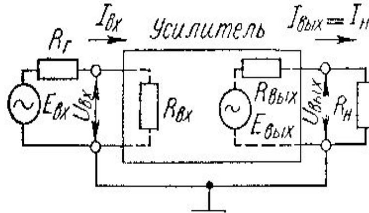
$$U_{BX} = E_{\Gamma} \frac{R_{BX}}{R_{BX} + R_{\Gamma}}$$
