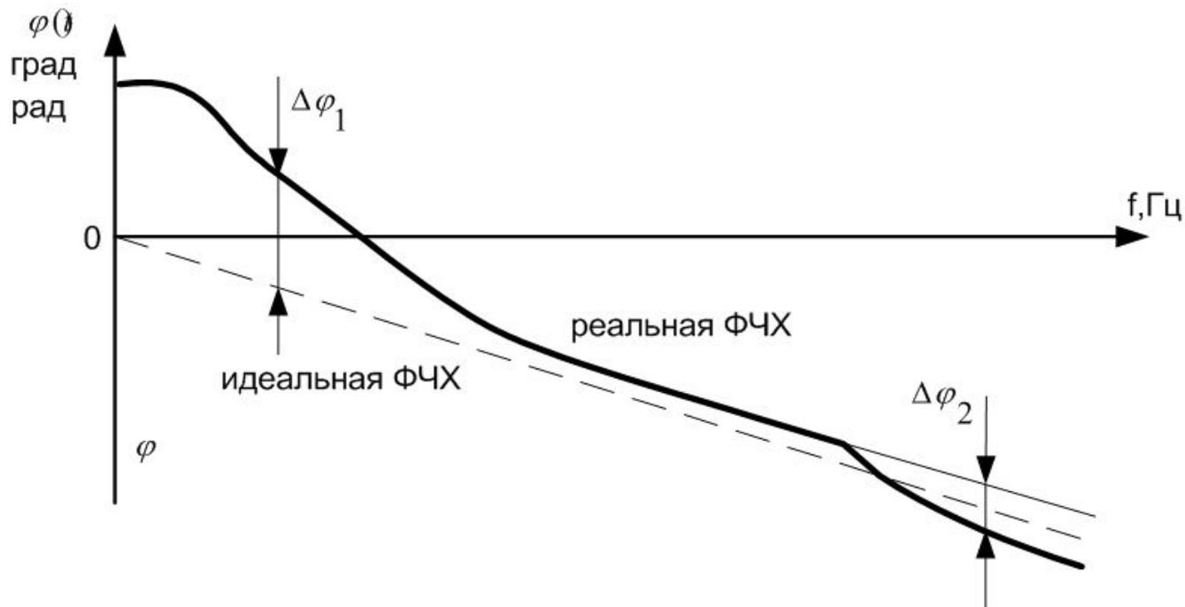
Фазо-частотная характеристика усилителя
