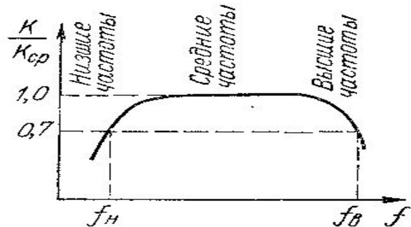
Степень искажений оценивается коэффициентом частотных искажений  $M$ , равным отношению коэффициента усиления на средней частоте к коэффициенту усиления на заданной частоте.
