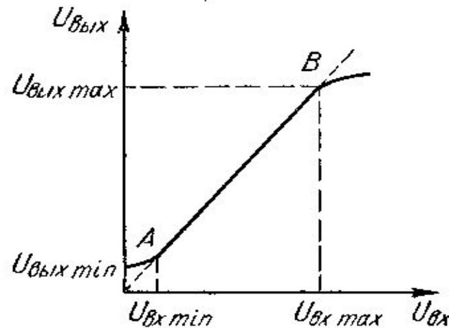
Отношение амплитуд максимального и минимального значений напряжения входного сигнала наз. *динамическим диапазоном усилителя*
