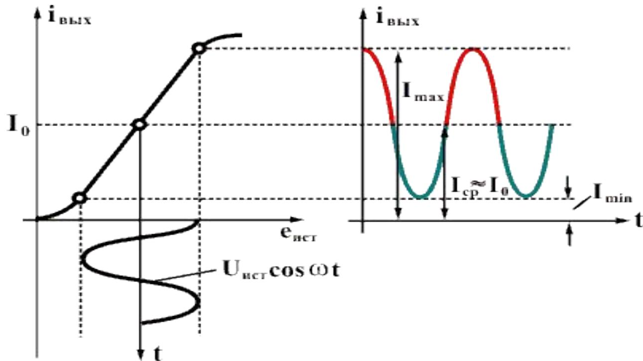
Нелинейные искажения представляют собой изменение формы кривой усиливаемого сигнала, вызванное нелинейными свойствами цепи, через которые проходит сигнал.
