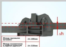
Недопустимая разность высот продольных осей автосцепок
