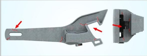
Трещины на корпусе автосцепки
