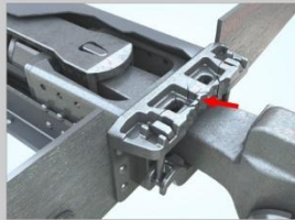
Недопустимая высота автосцепки над уровнем головок рельс
