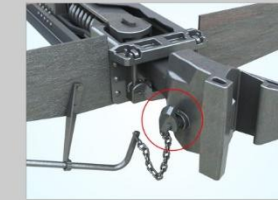
Нарушение крепления валика подъемника
