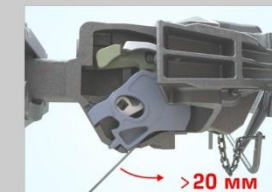
Неисправность предохранителя от саморасцепа
