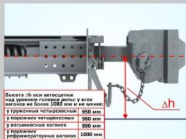
Недопустимая высота автосцепки над уровнем головок рельс
