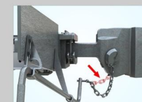
Несоответствие длины цепи расцепного привода
