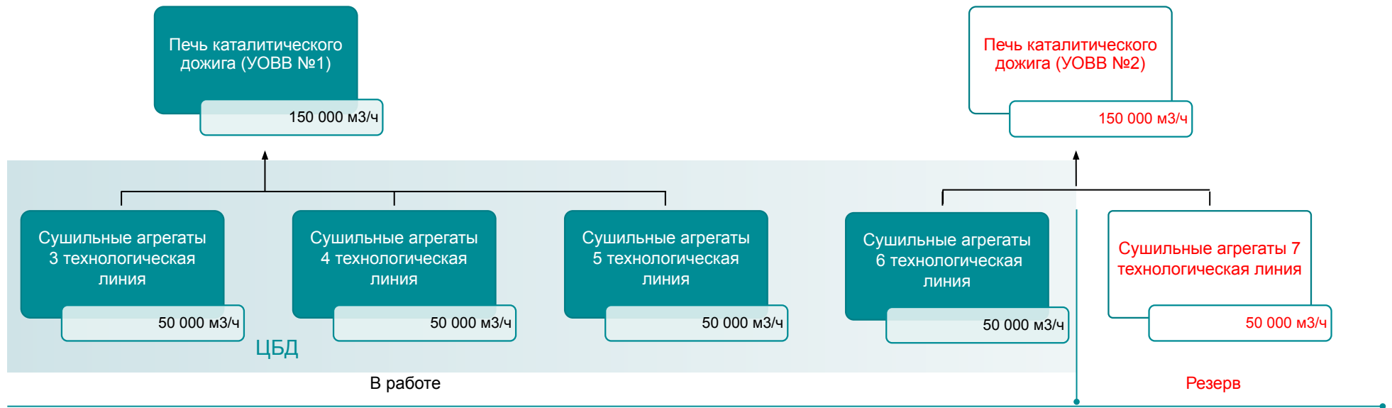
Действующая схема утилизации воздушных выбросов на установках каталитического дожига
