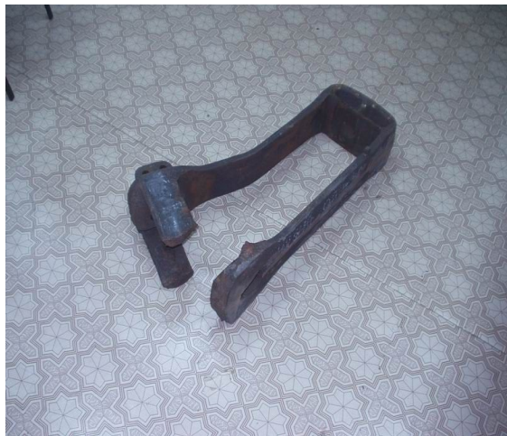
Трещина тягового хомута
