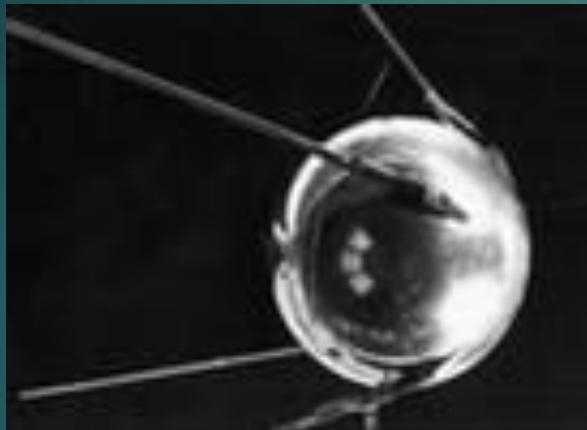
**Электрохимические источники тока обеспечили в полете работу аппаратуры в течение 3 недель. Искусственный спутник Земли просуществовал 92 суток, совершив ~1400 оборотов вокруг Земли. 4.1.1958 г. он вошел в плотные слои атмосферы и сгорел.**
