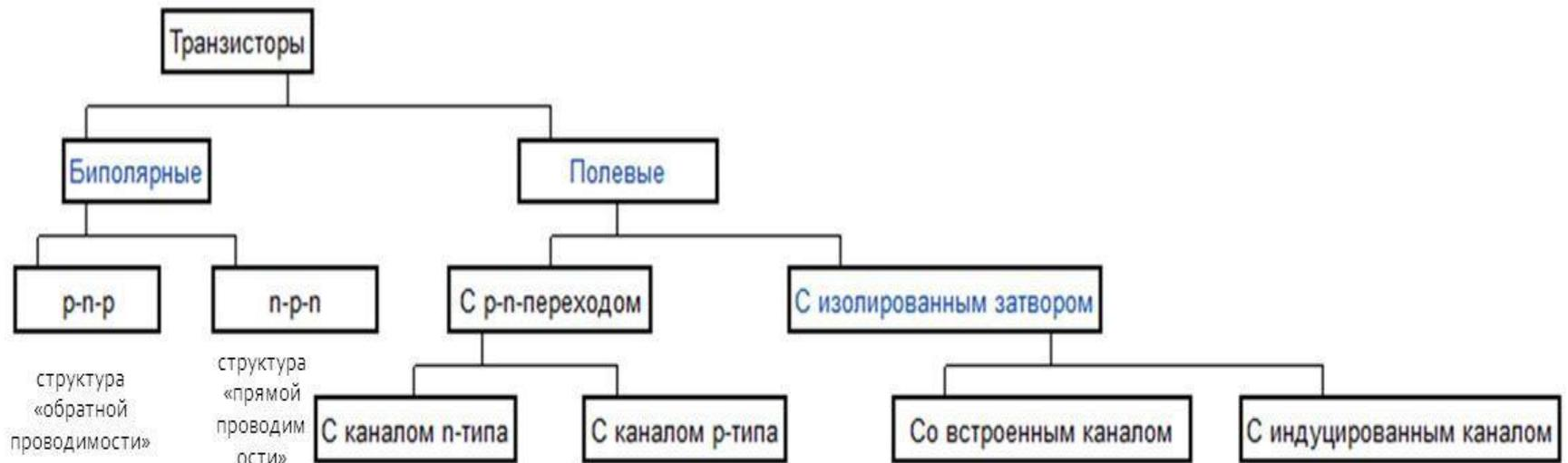
Биполярные транзисторы бывают двух типов проводимости: *n-p-n* и *p-n-p*:
