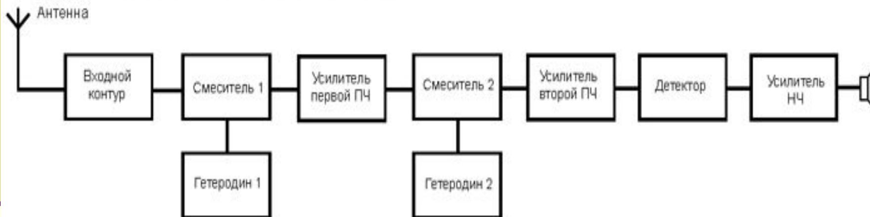
Блок-схема супергетеродинного приемника с двойным преобразованием частоты.
