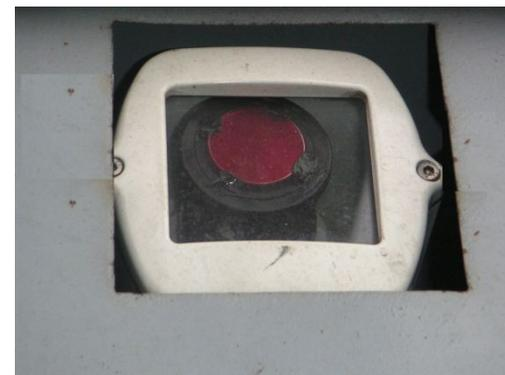
**Видеокамеры включения и выключения черно-белого изображения предназначенные для обзора монтируются в термокожухе, их питание осуществляется от источника питания напряжением 12 В.**
