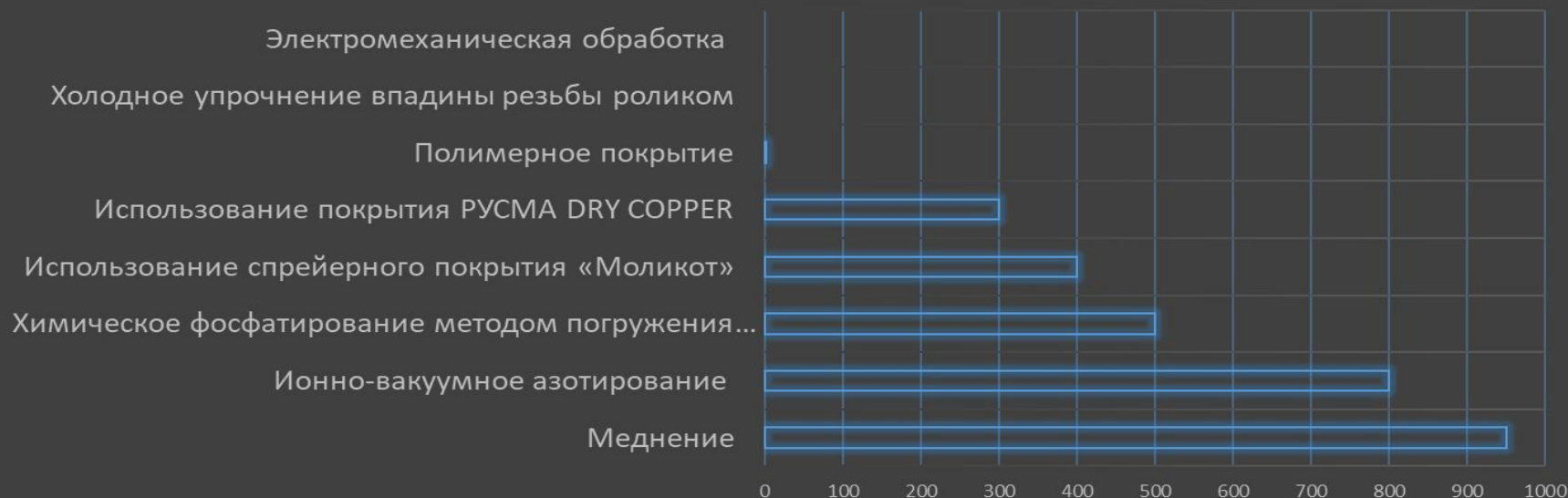
Испытания резьб с применением дополнительной обработки
