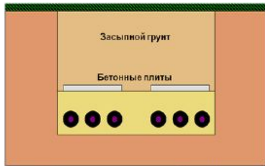
Схема прокладки кабелей в траншее
