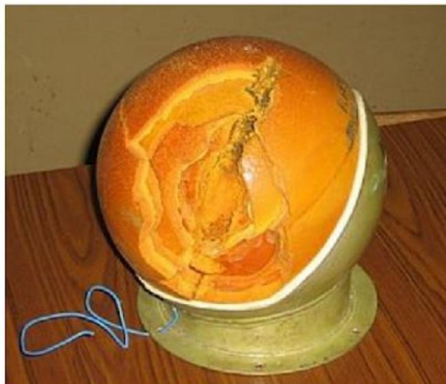
Рис. 5. Линза Люниберга: принцип действия и внешний вид «в расколе»
