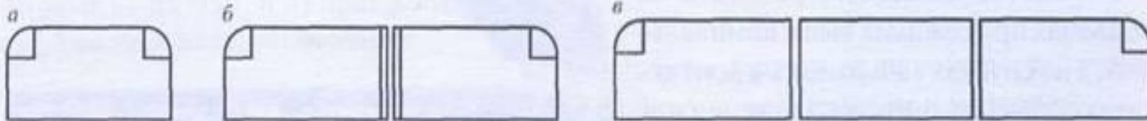
Рис. 6.7. Локомотивы: a — односекционные; б — двухсекционные; в — многосекционные
