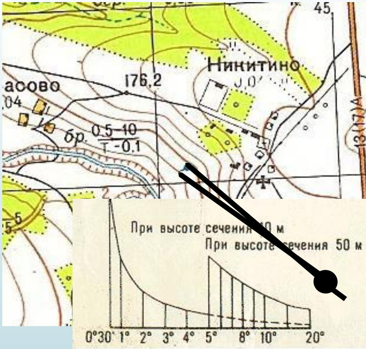
Решение : Сначала необходимо с помощью циркуля-измерителя измерить расстояние между двумя смежными основными горизонталями в районе ключа по направлению ската.
