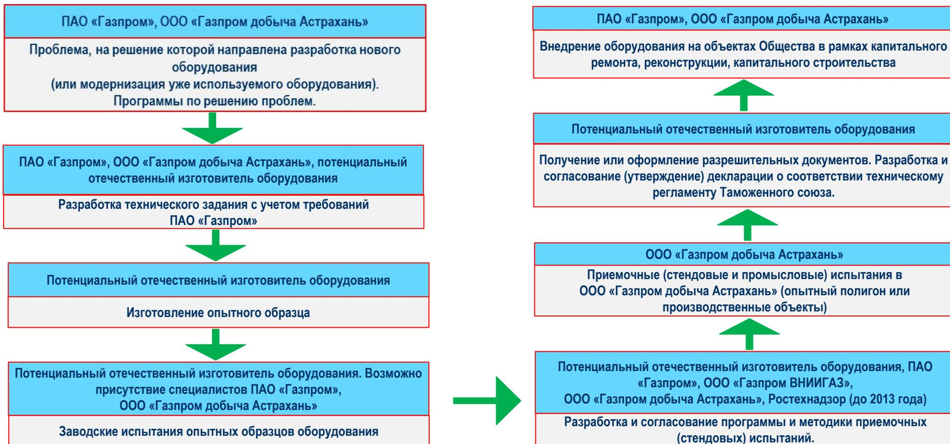
Указанный порядок является упрощенным, т.к. не учитывает проектную стадию, а также стадию внесения оборудования в Перечень оборудования, разрешенного к применению на объектах ПАО «Газпром» и Перечень основного технологического оборудования с длительным сроком изготовления по объектам капитального строительства и реконструкции для проведения конкурентных закупок в ходе проектно-изыскательских работ (Приказ от 19.09.2013 № 332)
