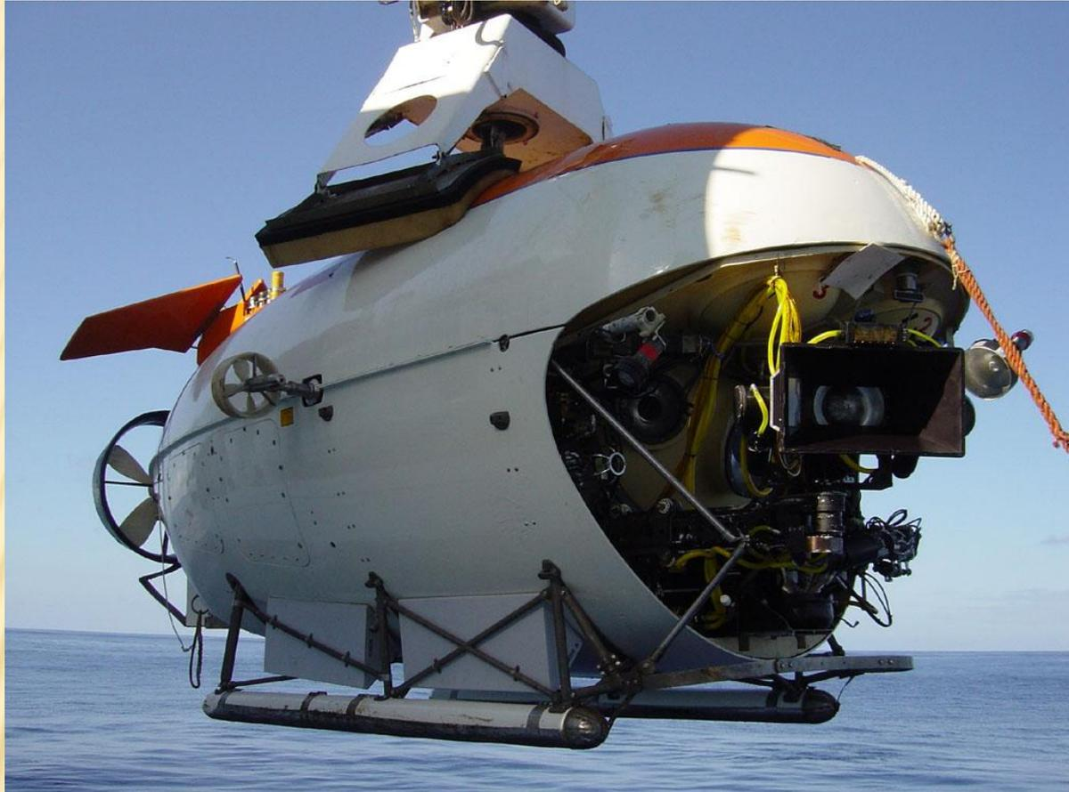
**Батиска́ф** (Bathyscaphe) (от греч. βάθυς — глубокий и σκάφος — судно) — подводный автономный (самоходный) обитаемый аппарат для океанографических и других исследований. Кроме этого используется для туристических целей и работ на больших глубинах. Двигается батискаф с помощью гребных винтов, приводимых в движение электромоторами.
