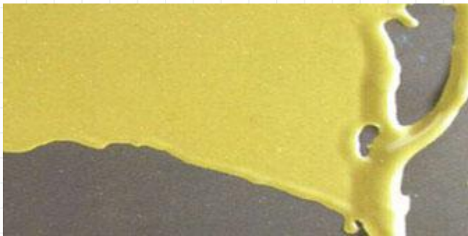
Стягивание полимерной пленки в одну из сторон, что приводит к оголению соседних участков
