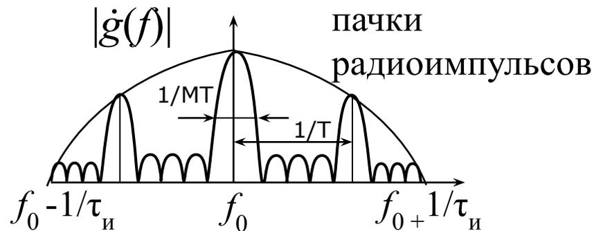
Область частот, в пределах которой сосредоточена основная часть всей энергии сигнала, называется шириной спектра  $\Delta f_c$ . Обычно ширина спектра определяется полосой частот, где сосредоточено  $\sim 90\%$  энергии сигнала. Например, ширина спектра прямоугольного радиоимпульса и их пачки **равна**  $\Delta f_c = 1/\tau_{и}$ .
