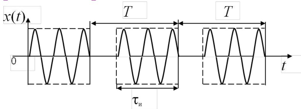
Если начальная фаза радиоимпульсов  $\varphi_k$  в последовательности постоянная или изменяется по известному закону, то такая последовательность когерентная.
