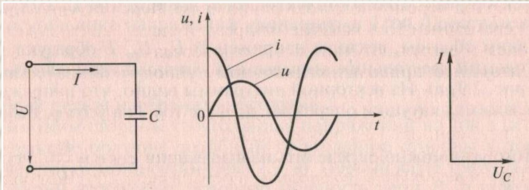
В цепи с емкостью  $C$  ток  $I$  опережает напряжение  $U$  по фазе на угол  $\varphi = 90^\circ$
