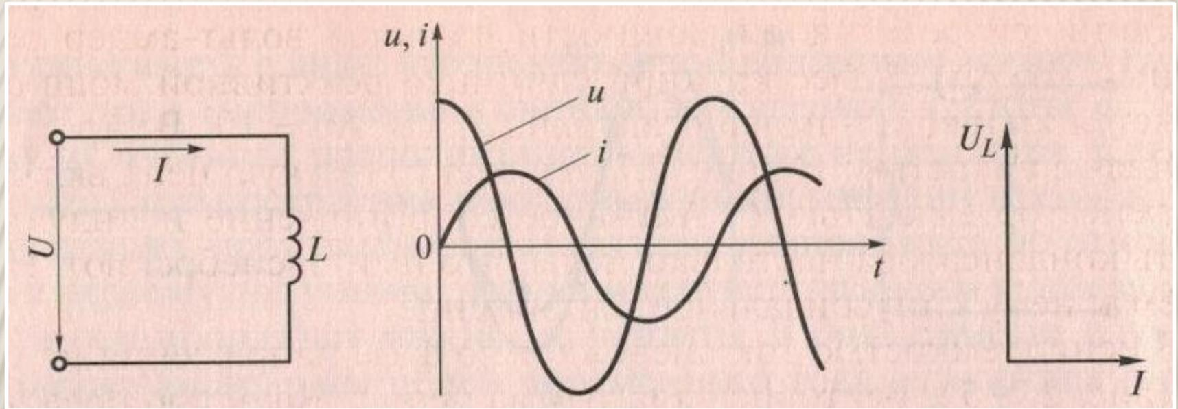
В цепи с индуктивностью  $L$  ток  $I$  отстает от напряжения  $U$  по фазе на угол  $\varphi = 90^\circ$  (идеальная катушка индуктивности)
