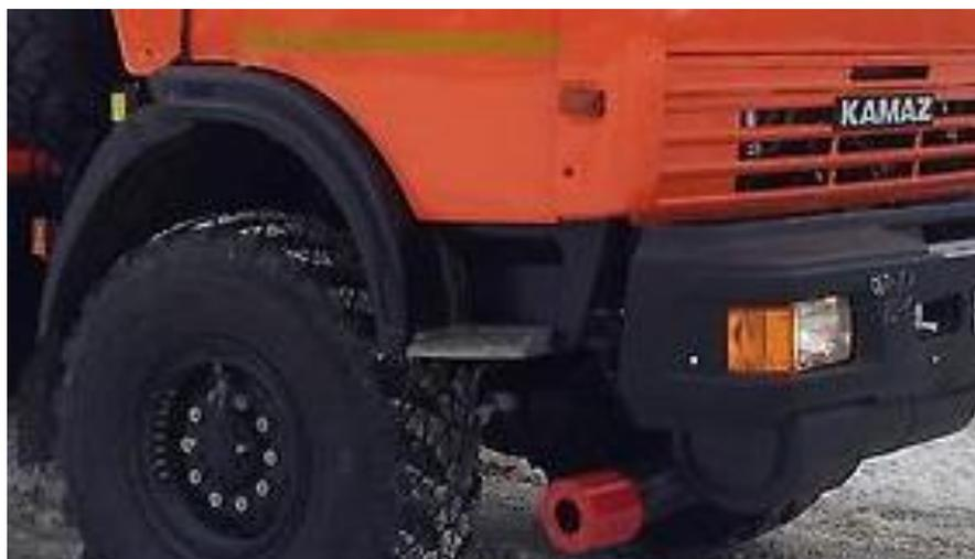
Все автотранспортные средства, эксплуатируемые на производственных объектах, должны быть оснащены искрогасителем внешнего типа.
