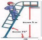
при осуществлении работником подъема на высоту более 5 м, или спуска с высоты более 5 м по лестнице, угол наклона которой к горизонтальной поверхности составляет более 75°;
