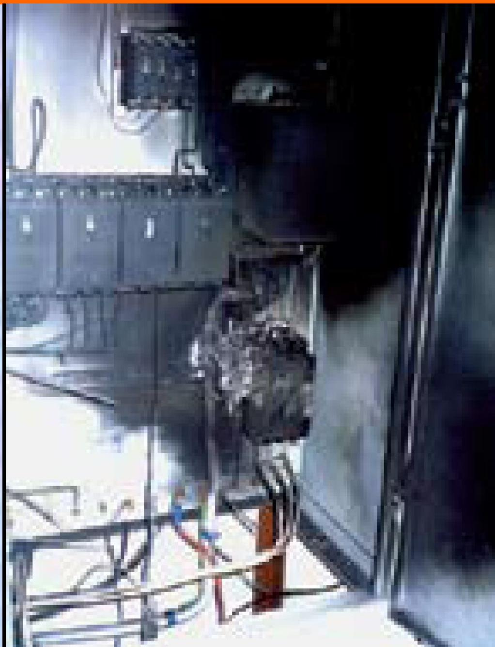
Сказанное выше относится не только к варисторным устройствам, но и к УЗИП на базе разрядников, которые не имеют в своем составе терморасцепителя. Для того чтобы предотвратить подобные последствия рекомендуется устанавливать последовательно с устройствами защиты от импульсных перенапряжений предохранители.
