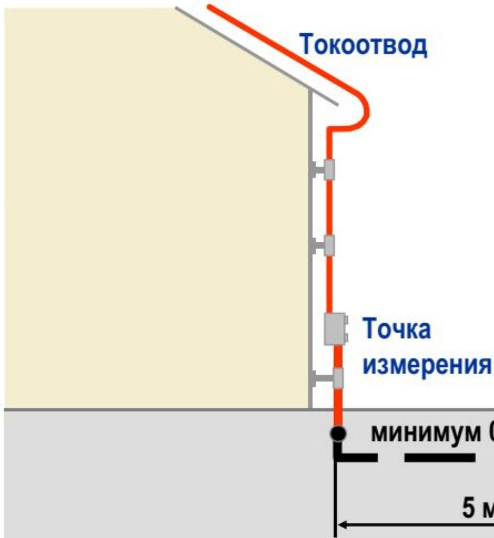
Если сопротивление заземлителя превышает 10 Ом, минимальная длина заземлителя должна быть не менее указанной на Рис.2. Каждый токоотвод соединяется с горизонтальным заземляющим электродом, который закапывается в грунт на длину 5 метров и на глубину не менее полуметра. В случае необходимости, горизонтальный заземляющий электрод может быть соединен с дополнительным вертикальным электродом.
