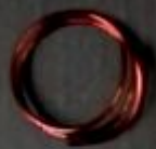
Провод медный обмоточный D1 мм
