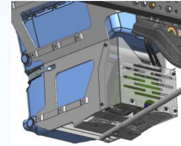
Бак AdBlue – 100 л, совмещен с дозирующим насосом и задней частью крыла. С защитой насоса от грязи, камней
