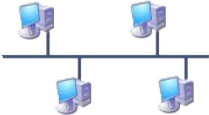
Компьютеры соединены последовательно и подключены к одному кабелю. Заглушки необходимы для поглощения передаваемого сигнала на концах.
