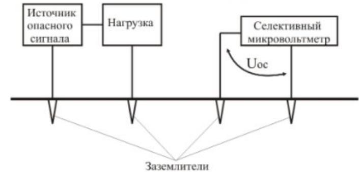
Утечка информации по общей цепи заземления двух различных устройств
