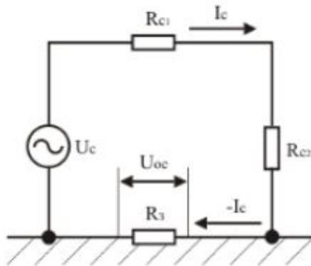
Утечка информации по цепям заземления, обусловленная наличием электромагнитного поля в грунте
