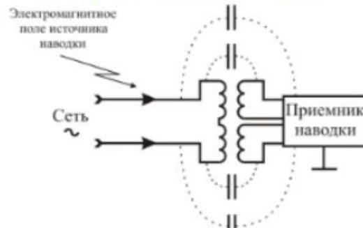
Утечка информации по цепям электропитания за счет побочного электромагнитного излучения
