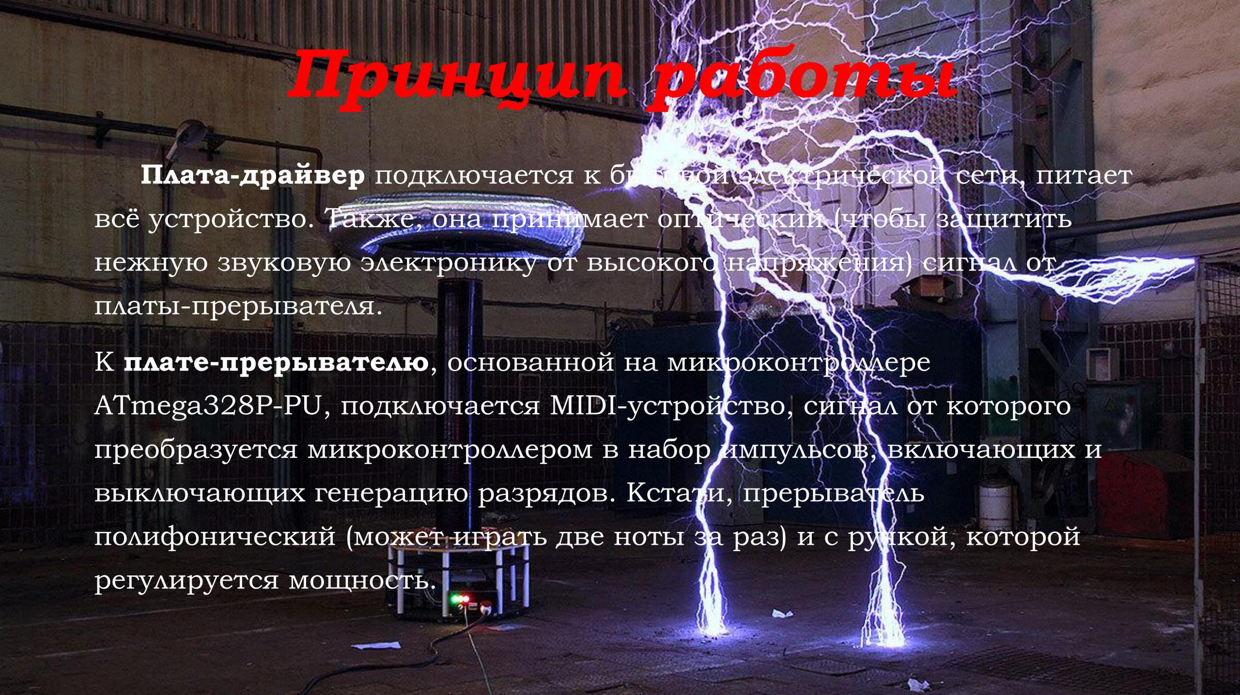
**Плата-драйвер** подключается к бытовой электрической сети, питает всё устройство. Также, она принимает оптический (чтобы защитить нежную звуковую электронику от высокого напряжения) сигнал от платы-прерывателя.
