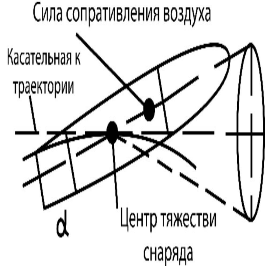
Рис. 2.12 Движение вращающегося снаряда в воздухе
