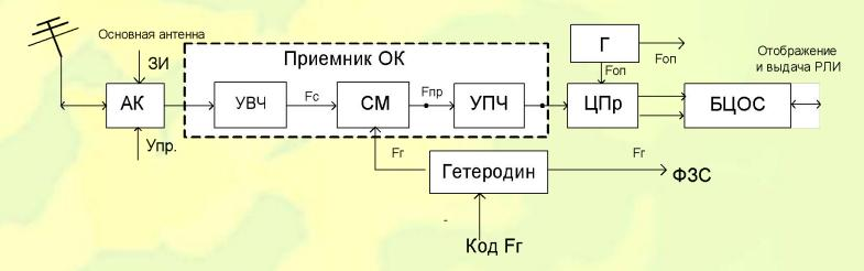
С другого выхода синтезатора частоты (гетеродина) выдается напряжение гетеродинной частоты в передающую систему для формирования несущей частоты зондирующего сигнала.
