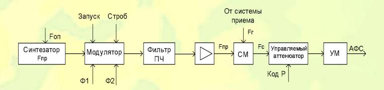
После прохождения фильтра промежуточной частоты (ПЧ) и усиления, сигналы на ПЧ выдаются в смеситель СМ, где происходит их перенос на несущую частоту. На второй вход смесителя поступает напряжение частоты гетеродина приемной системы в диапазоне от 215 до 255 МГц. На выходе смесителя выделяется разностная частота от 140 до 180 МГц, являющаяся несущей частотой сигнала.
