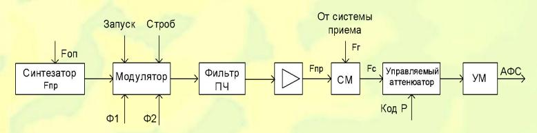
В синтезаторе вырабатываются высокостабильные колебания промежуточной частоты  $F_{np}$  равной 75 МГц. Синхронизация синтезатора осуществляется напряжением опорной частоты  $F_{on}$ , равной 60 МГц, которым тактируется также и АЦП цифрового приемника. Этим обеспечивается когерентность формирования и обработки сигналов в передающей и приемной системах.
