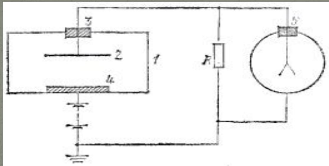
Измерение ионизационного тока: 1 — корпус ионизационной камеры, 2 — электрод, отделенный от 1 изолирующей пробкой 3,4 — изучаемый препарат, 5 —электрометр. Сопротивление  $R=108—1012$  Ом. При достаточно высоком напряжении батареи все ионы, образуемые в объеме камеры ионизующим излучением, собираются на электроды, и через камеру течет ток, пропорциональный ионизационному действию препарата, В отсутствие ионизующих агентов воздух в камере является непроводником, и ток равен нулю.
