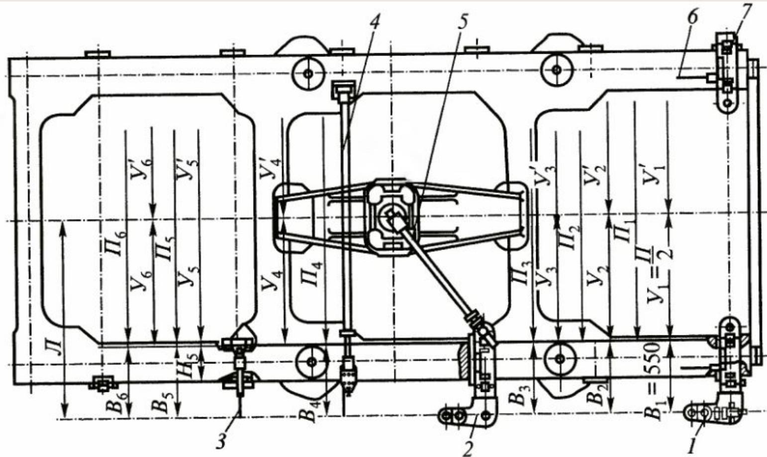
Схема измерения рам тележек тепловозов 2ТЭ10В и 2ТЭ116:
