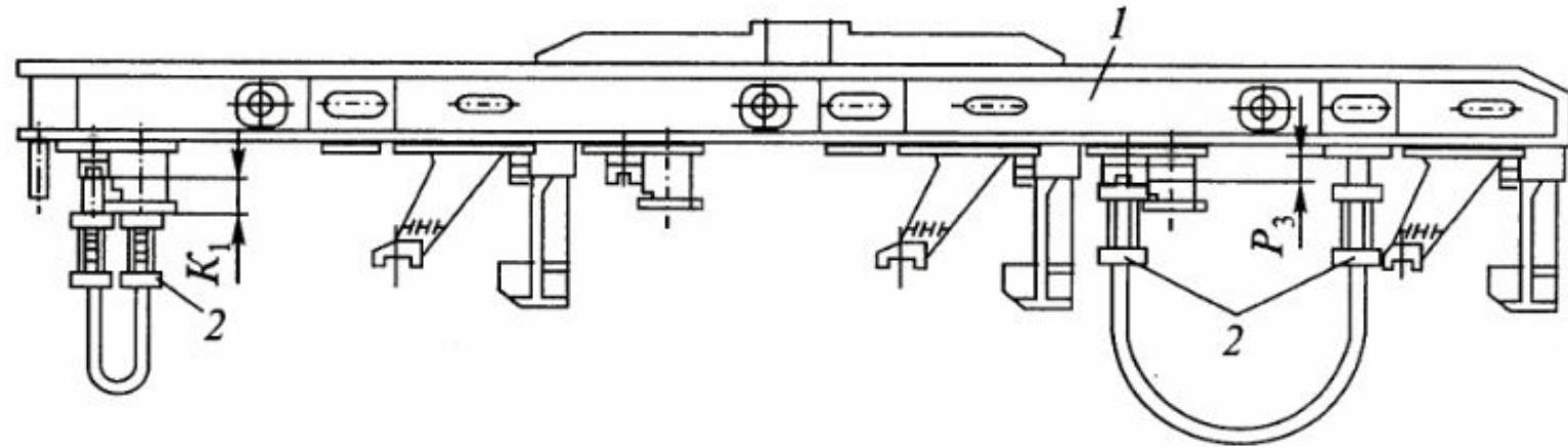
Измерение расстояния по вертикали между опорными поверхностями под пружины:
