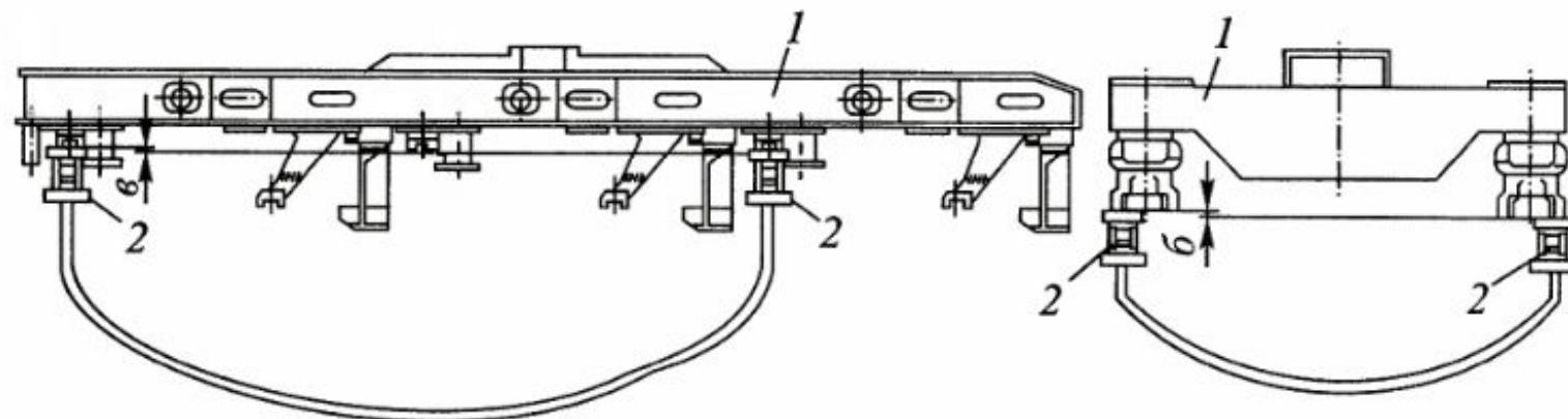
Проверка положения опорных поверхностей под пружины:
