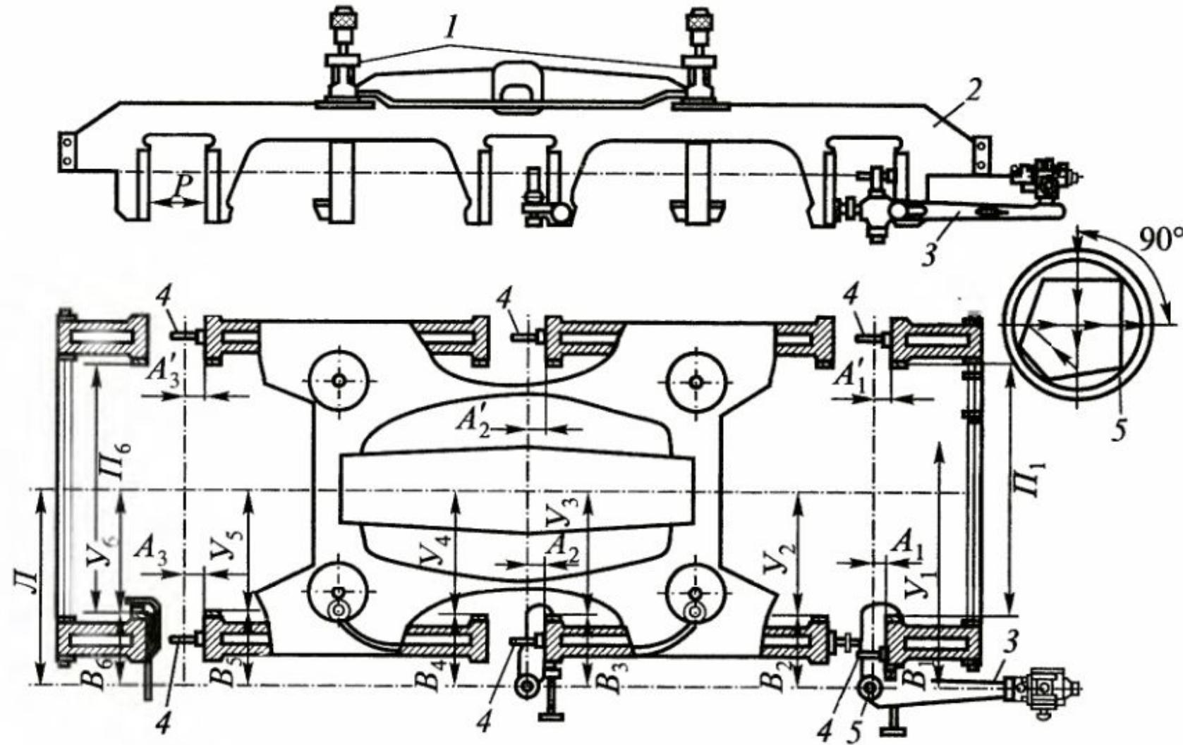
Схема оптической проверки рамы тележки тепловоза:
