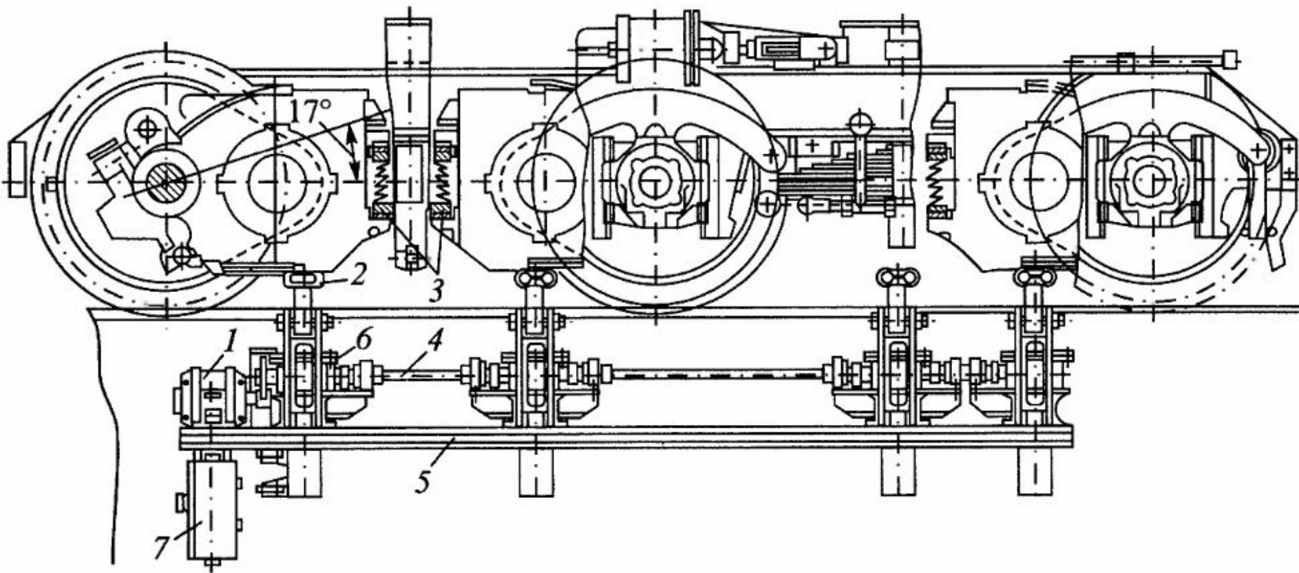
Подъемник А494 для поддержки тяговых электродвигателей при разборке и сборке тележек:
