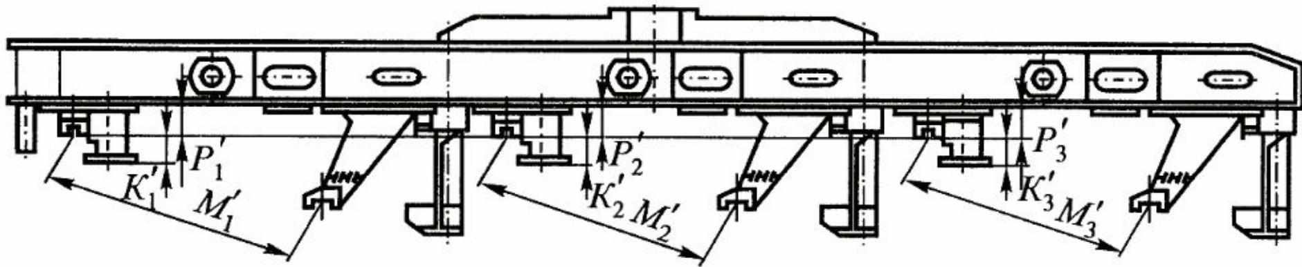
Схема измерения расстояний до опорных поверхностей проушин и между серединами клиновых пазов тепловозов 2ТЭ10В, 2ТЭ116 (показана левая сторона тележки)
