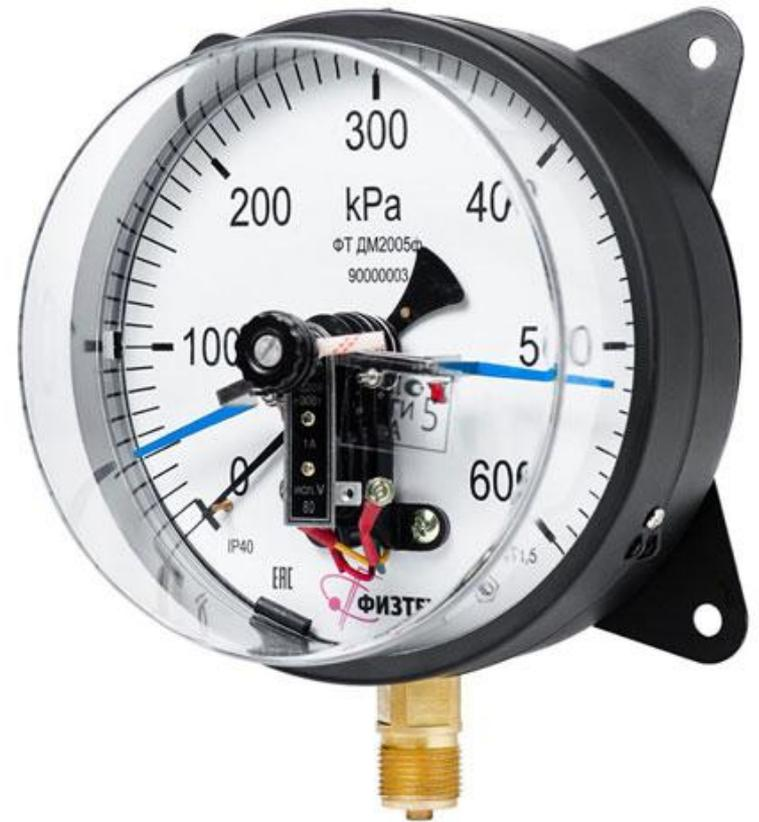
**Электроконтактный манометр** — это датчик, который применяется для измерения избыточного и вакуумметрического давлений в разных средах (жидкость, газ, пар), используется в качестве сигнализирующего устройства прямого действия и позволяет управлять производственными процессами, при этом особым условием к среде является исключение ее кристаллизации.
