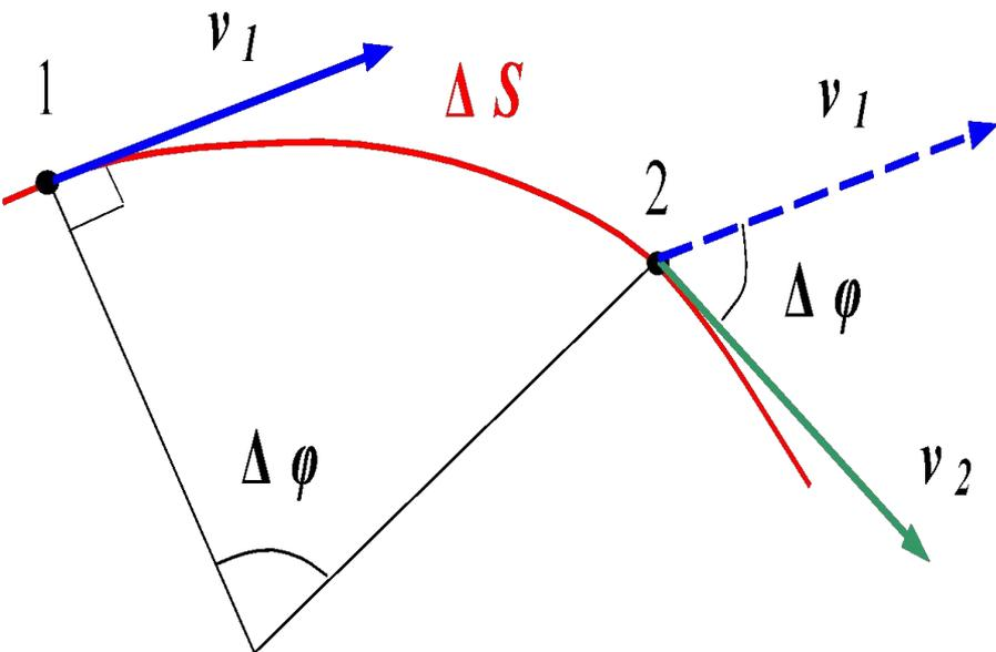
$\Delta\varphi$  - угол между касательными в точках, отстоящих друг от друга на расстоянии  $\Delta S$ .
