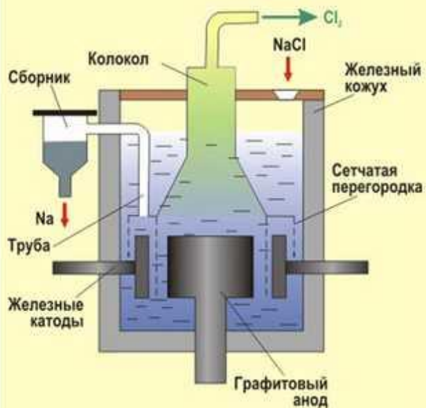
Схема установки для получения металлического натрия
