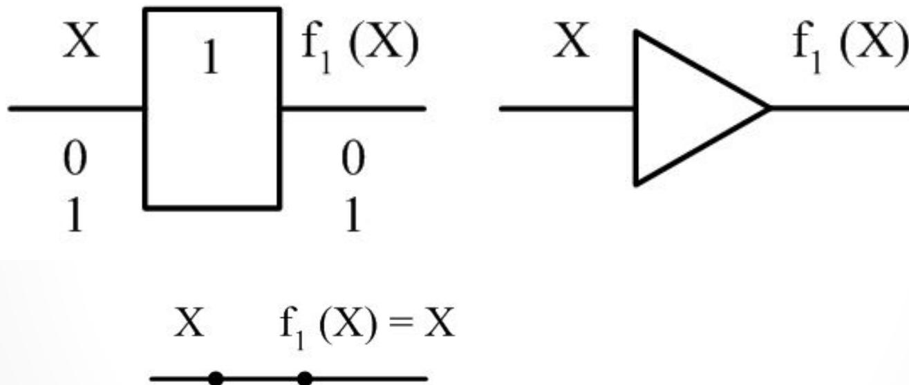
Повторители в цифровой схемотехнике используются для усиления сигнала по мощности, т.е. для увеличения нагрузочной способности логических элементов.
