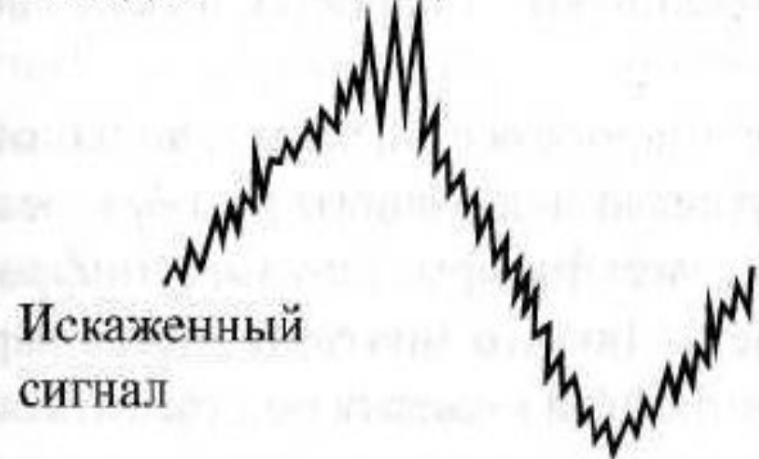
Искажение шумами и наводками аналогового (слева) и цифрового (справа) сигналов
