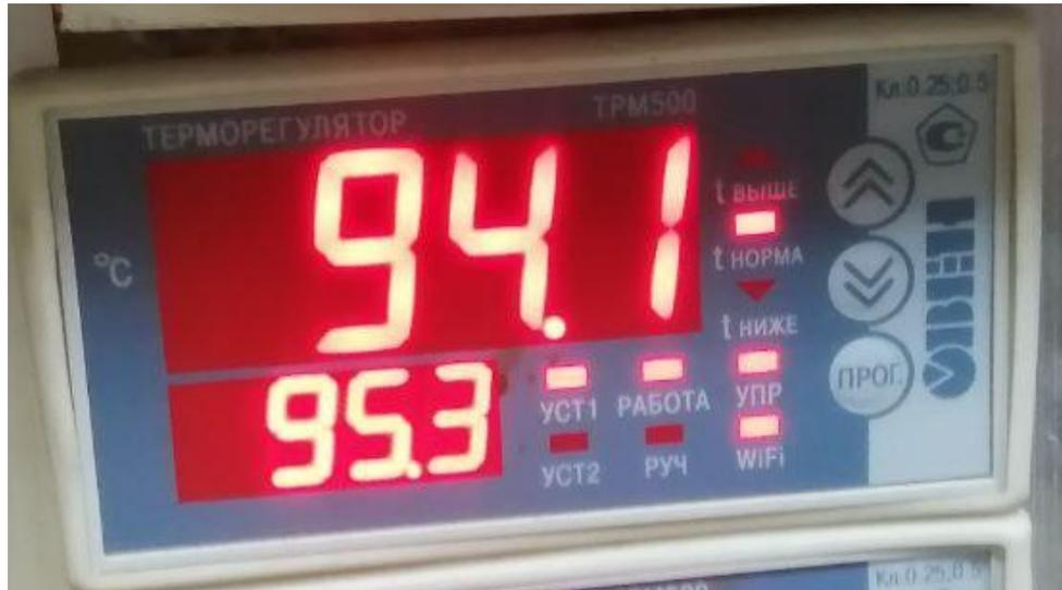
**Показание температуры расплава КF-2HF с лабораторной термопары на терморегуляторе**
