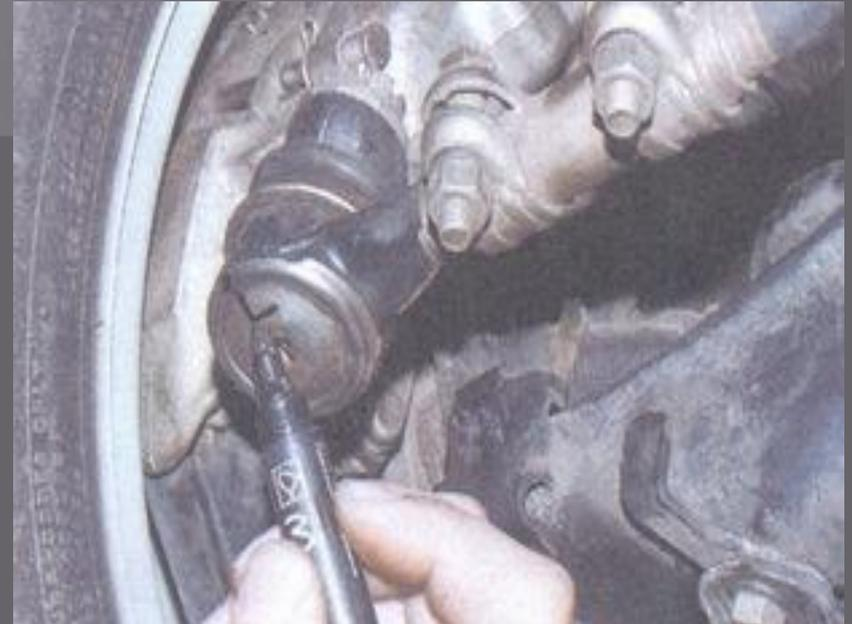
ОЧИСТИТЕ ВСЕ ШАРОВЫЕ ШАРНИРЫ СО ВСЕХ СТОРОН ОТ РЖАВЧИНЫ И ГРЯЗИ ЩЕТКОЙ, А ЗАТЕМ ТРЯПКОЙ. ОСМОТРИТЕ ПЫЛЬНИКИ ШАРНИРОВ РУЛЕВЫХ ТЯГ НА ОТСУТСТВИЕ ТРЕЩИН, РАЗРЫВОВ И ОТСЛОЕНИЙ РЕЗИНЫ СДАВИТЕ ПЫЛЬНИК ПАЛЬЦАМИ. ВЫХОД СМАЗКИ НАРУЖУ НЕ ДОПУСКАЕТСЯ. ПОВТОРИТЕ РАБОТУ ДЛЯ ВСЕХ ШАРНИРОВ. ДЕФЕКТНЫЕ ПЫЛЬНИКИ ЗАМЕНИТЕ.
