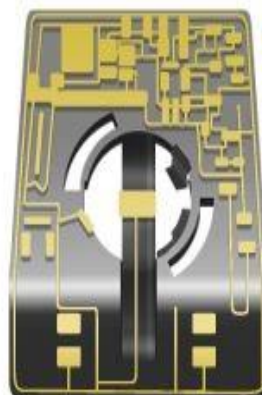
Трехмерная система на пластике 3D-MID
