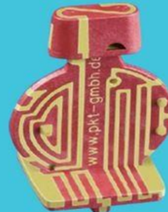
Нанесение покрытия меди/никеля/золота
