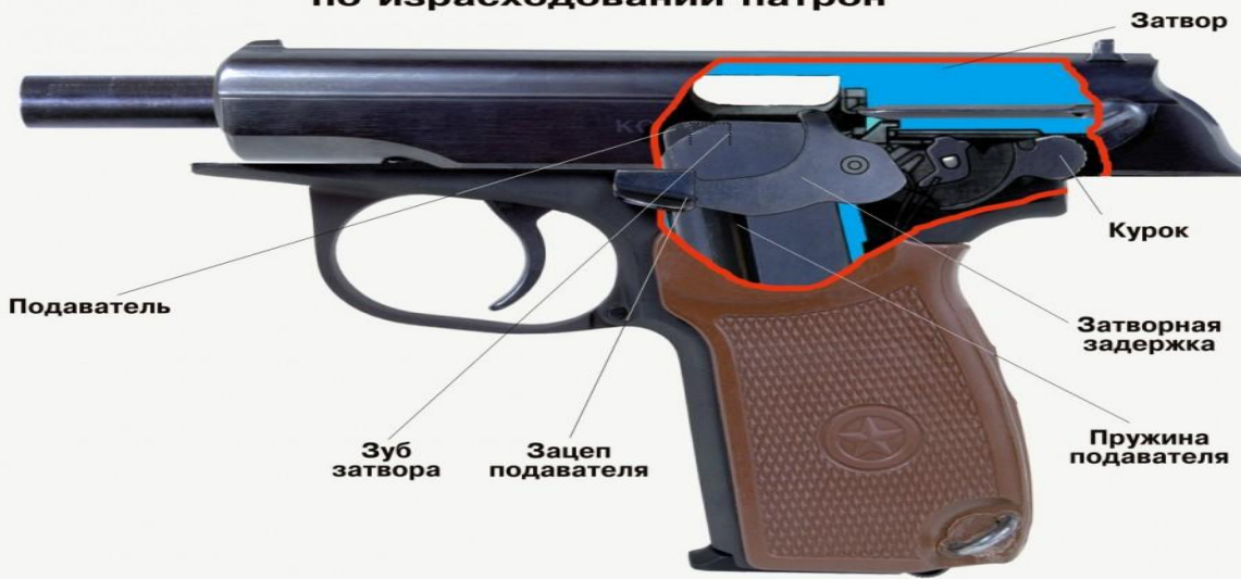
Положение частей и механизмов пистолета по израсходованию патрон
