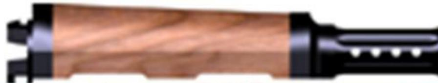
Газовая трубка служит для направления движения газового поршня
