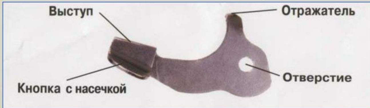
служит для удержания затвора в заднем положении по израсходовании всех патронов из магазина. Она имеет: в верхней части - выступ, для удержания затвора в заднем положении; кнопку с насечкой для освобождения затвора нажатием на нее большим пальцем; в задней части - отверстие для соединения с левой цапфой шептала; в верхней части - отражатель для отражения наружу гильзы (патрона) через окно затвора. Затворная задержка передней частью вставляется в вырез в левой стенке рамки.
