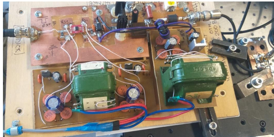
Рис.6 Фотография и схема формирователя импульсов
