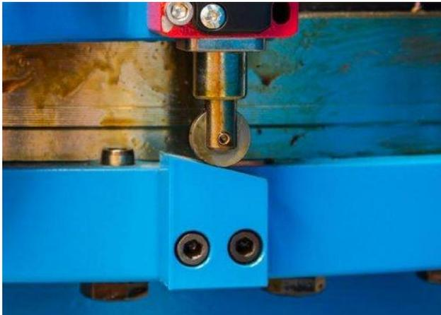
Пример простого дискретного сигнала на два значения: срабатывание путевого выключателя (переключение контактов выключателя в определенном положении механизма). Сигнал с путевого выключателя может быть получен только в двух вариантах – контакт разомкнут (нет действия, нет напряжения) и контакт замкнут (есть действие, есть напряжение).
