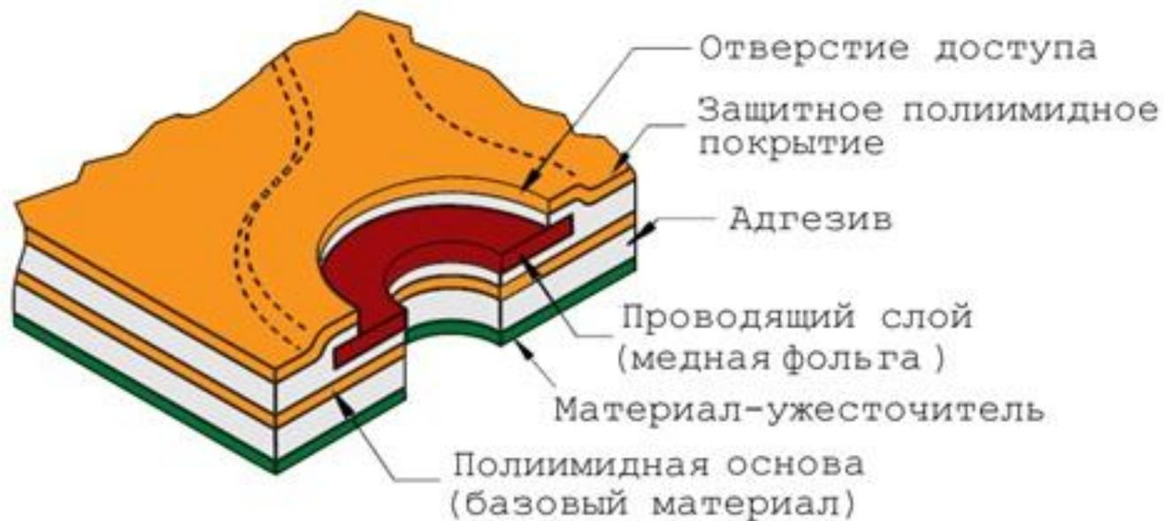
Односторонняя гибкая печатная плата с упрочнением
